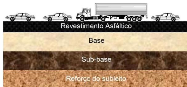
Figura 6 - Pavimento flexível constituído por revestimento, base, sub-base e reforço do subleito.
