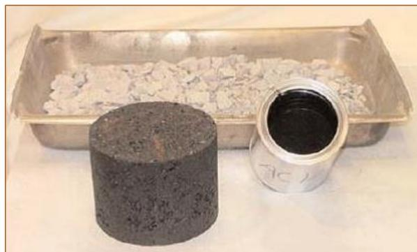
Figura 56 - Materiais (agregados e ligante asfáltico) e corpo de prova moldado em laboratório. Fonte NCHRP, 2011.
