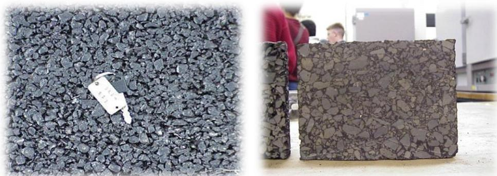
Figura 35 - Detalhe do contato pedra-pedra em um SMA.
