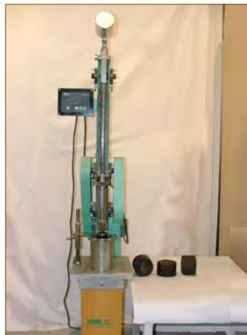
Figura 60 - Compactador Marshall.
