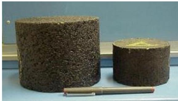
Figura 63 - Corpos de prova de 150 e de 100 mm de diâmetro moldados com compactador giratório. Fonte: NCHRP, 2011.
