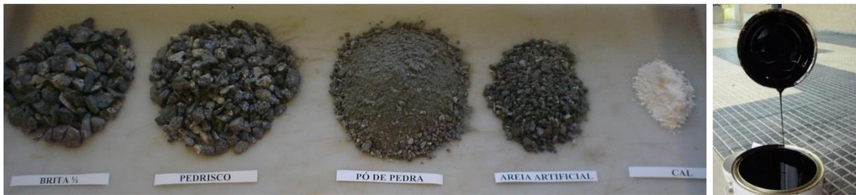
Figura 57 - Exemplo de materiais utilizados em uma mistura asfáltica.
