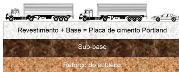
Figura 7 - Pavimento rígido constituído por placa de concreto de cimento e sub-base.
