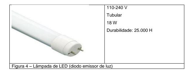
Um projeto piloto de substituição de lâmpadas fluorescentes por lâmpadas de LED nas áreas comuns nos prédios 54/56 e 70 foi idealizado e para a execução foi feita uma aquisição de lâmpadas de LED de 18 W instaladas em substituição as lâmpadas fluorescentes de 32 W e os respectivos reatores.
