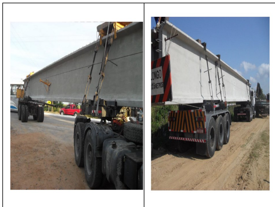
Imagem 16 – Transporte de Vigas de 20m
